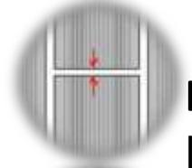
**EXTREMO A EXTREMO:** El espacio entre los extremos de la placa depende de 3 factores; la longitud de la placa, la temperatura durante la instalación y la temperatura máxima local. Ver tabla de separación.
